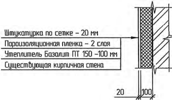
Деталь звукоизоляции стены по оси 9 на техническом этаже
