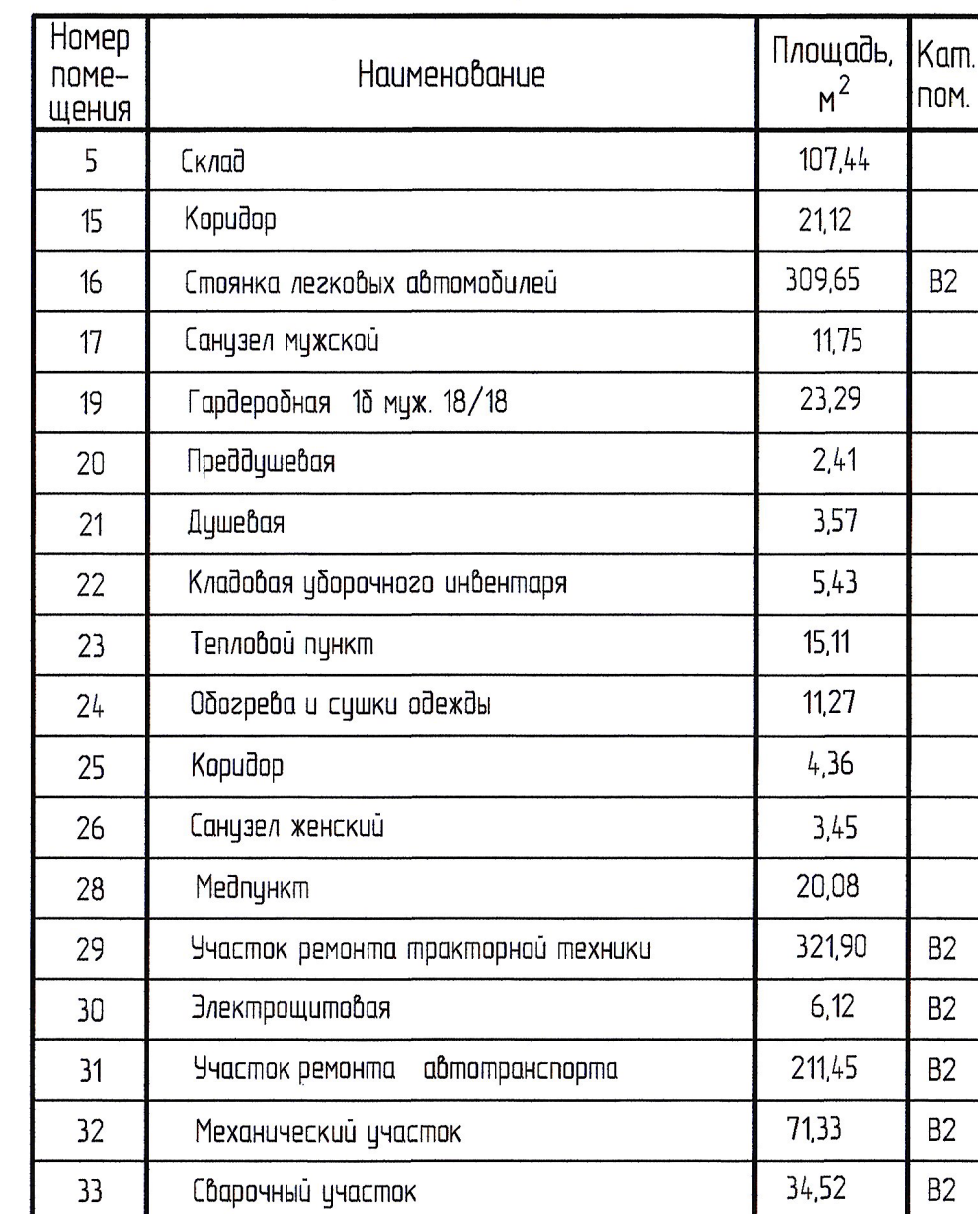
Экспликация помещений 1 этажа
